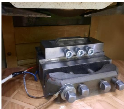
Рис. 2. Столик динамометра УДМ-600 с установленным образцом
