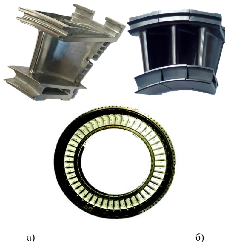
Рис. 1. Общий вид расположения различных разнонаправленных обрабатываемых поверхностей сопловой лопатки турбины (а), предназначенных для точного расположения в сопловом аппарате турбины при сборке (б)
