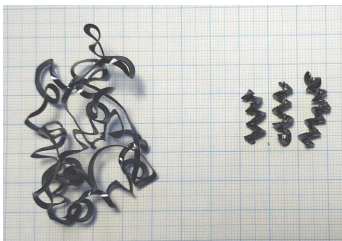
Рис. 2. Образцы стружки: слева – сливная; справа – элементная
