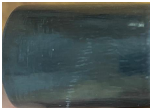
Рис. 1. Средняя часть образца с покрытием толщиной 200 мкм после изгиба
