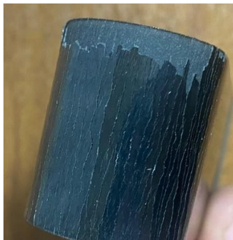
Рис. 2. Средняя часть образца с покрытием толщиной 300 мкм после изгиба
