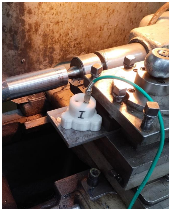
Рис. 1. Способ закрепления корпусного датчика
