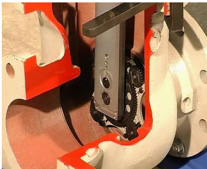
Рис. 1. Модернизация конструкция инструментального блока притирочно- доводочного станка
